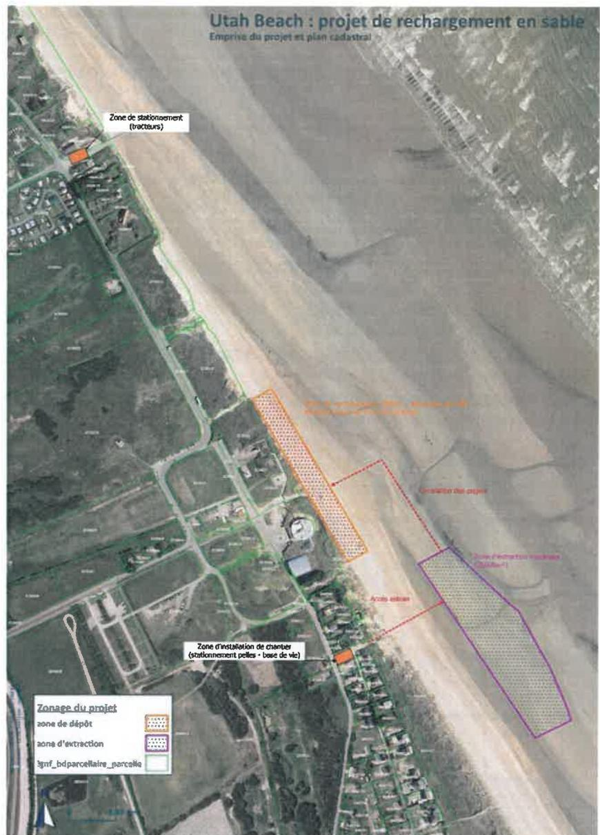
L'accès à l'estran se fera par la brèche aux chars, située au sud du musée, au niveau de laquelle sera mise en place une zone d'installation de chantier (stationnement des engins). Une deuxième zone de stationnement est prévue au niveau du parking de la cale de mise à l'eau, pour le stationnement diurne d'engins. L'accès à cette seconde zone de stationnement se fera par le réseau routier.
