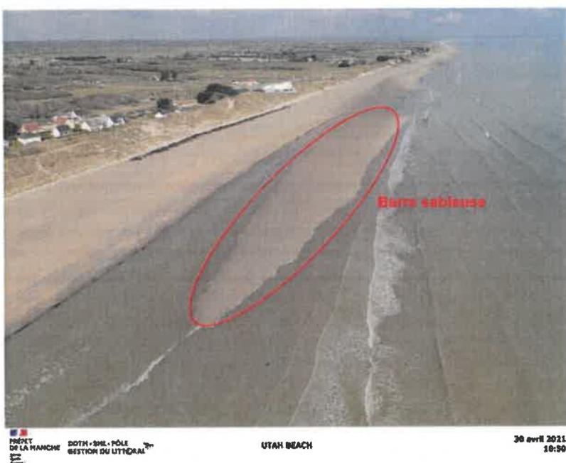
Afin de limiter l'effet des prélèvements sur ces barres sableuses, la profondeur d'extraction sera de 30 cm à 50 cm maximum.
